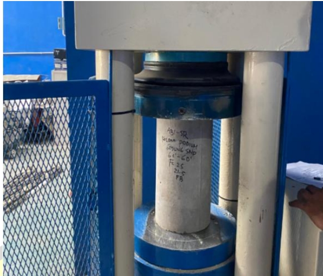
Gambar 75 Uji kuat tekan beton
