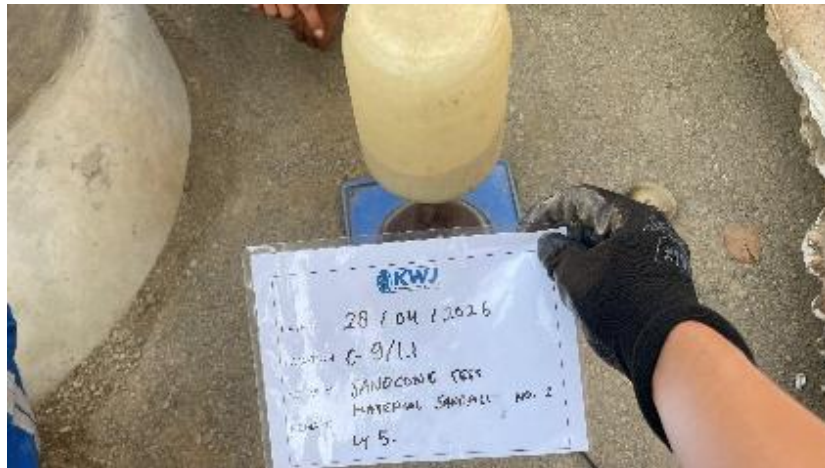
Gambar 3. 18 Uji Sand Cone Sumber: Penulis (2026)
