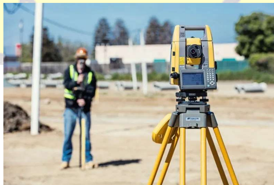
Gambar 2. 1 Pengukuran Menggunakan Alat Total station (Sumber : Geometri Makassar, 2026)
