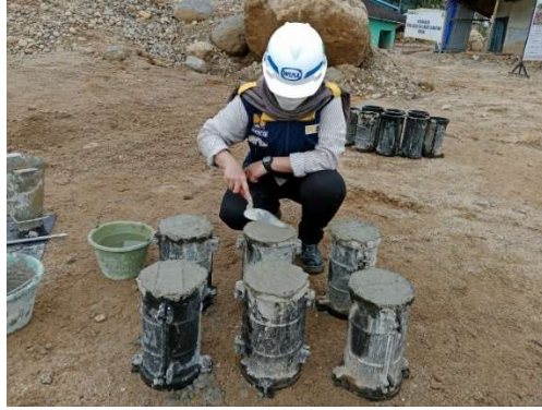
Gambar 3. 20 Pembuatan Benda Uji (Sumber: Dokumentasi Penulis, 2026)
