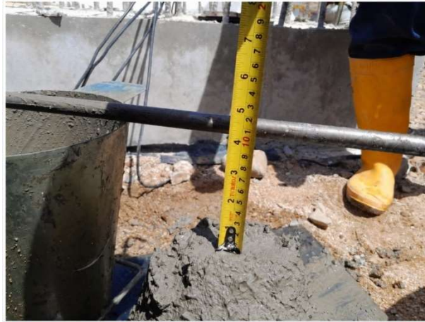
Gambar 4. 1 Pengujian Slump Komposisi 50:50 slump 10 \pm 2 cm (Sumber : Dokumentasi Pribadi, 2026)
