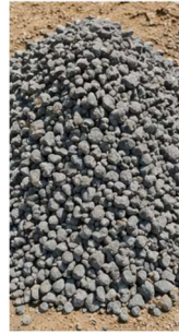
Gambar 3. 15 Batu Split 1-2 (Sumber: Dokumentasi Penulis, 2026)
