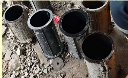
Gambar 3. 9 Molding Silinder Ø15 cm × 30 cm (Sumber: Dokumentasi Penulis, 2026)
