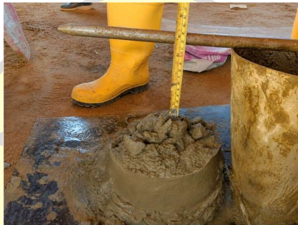
Gambar 4. 2 Pengujian Slump Komposisi 50:50 slump 12 \pm 2 cm (Sumber : Dokumentasi Pribadi, 2026)
