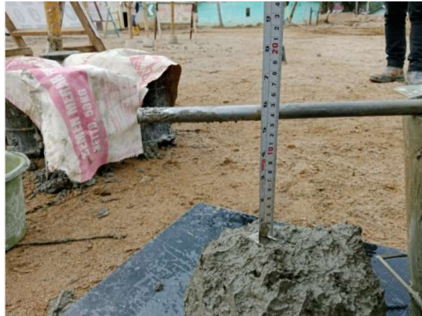
Gambar 4. 4 Pengujian Slump Komposisi 70:30 slump 12 \pm 2 cm (Sumber : Dokumentasi Pribadi, 2026)
