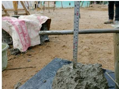
d. Slump test komposisi 70:30 slump 12 \pm 2 cm
