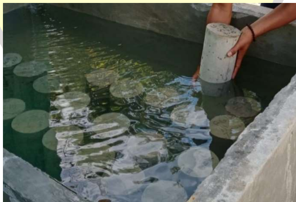
Gambar 3. 23 Perawatan Beton ( curing ) (Sumber: Dokumentasi Penulis, 2026)
