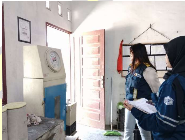
Gambar 3. 24 Pengujian Kuat Tekan (Sumber: Dokumentasi Penulis, 2026)
