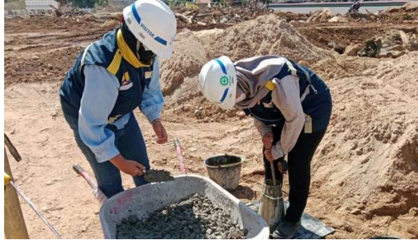
Gambar 3. 22 Slump Test di Lapangan (Sumber: Dokumentasi Penulis, 2026)
