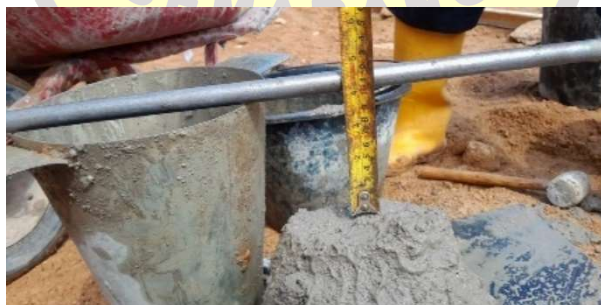
Gambar 4. 3 Pengujian Slump Komposisi 70:30 slump 10 \pm 2 cm (Sumber : Dokumentasi Pribadi, 2026)
