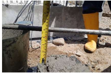
d. Slump test komposisi 70:30 slump 12 \pm 2 cm
