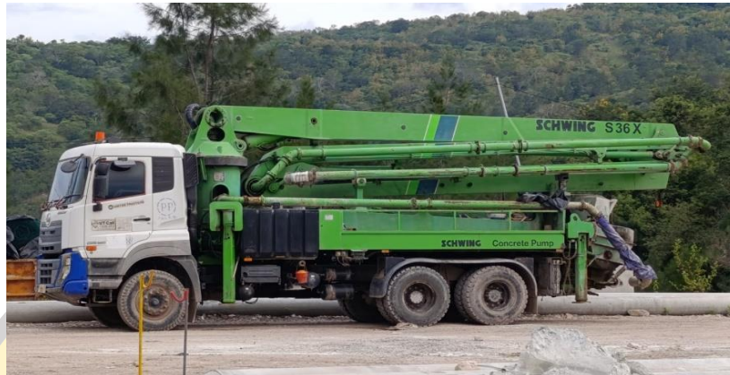
Gambar 4. 15 Concrete Pump Truck UD Quester (Sumber : Dokumentasi Pribadi, 2025)
