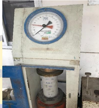
Gambar 4. 53 Pengujian Uji Kuat Tekan (Sumber : Dokumentasi Pribadi, 2025)
