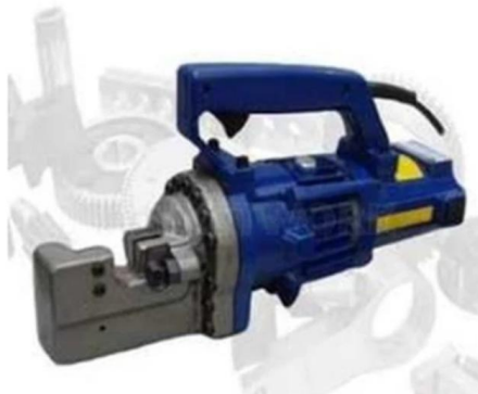
Gambar 3. 22 Alat Barcutter untuk penulangan dan pembesian
