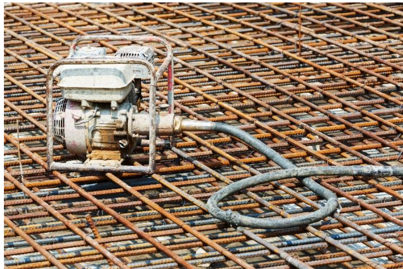
Gambar 3. 15 Concrete vibrator yang digunakan pada saat pekerjaan dilapangan
