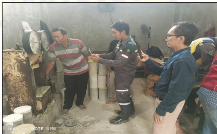
Gambar 4. 3 Dokumentasi Pengujian Kuat Tekan Beton Sumber : Dokumentasi Pribadi, 2024
