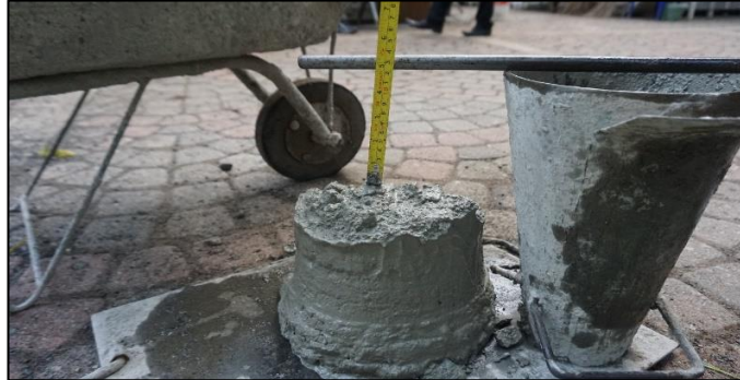
Gambar 4. 2 Dokumentasi Uji Slump Sumber : Dokumentasi Pribadi, 2024
