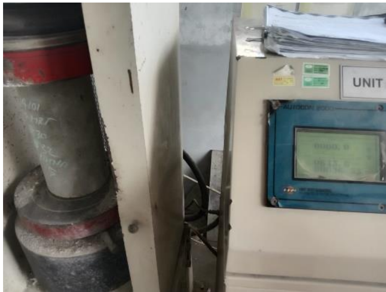
Gambar 38 Hasil pengujian kuat tekan beton. Sumber : Dokumentasi lapangan
