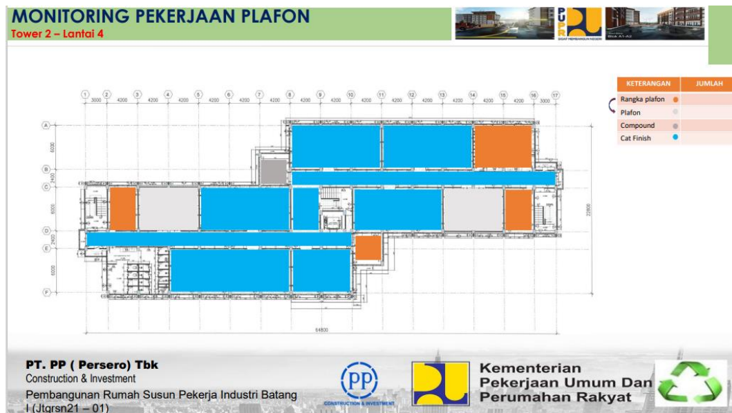
Gambar 148 Montitoring mapping progres pekerjaan plafond.
