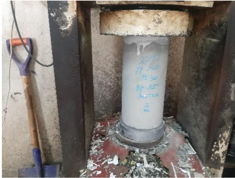
Gambar 37 Proses pengujian kuat tekan beton. Sumber : Dokumentasi lapangan
