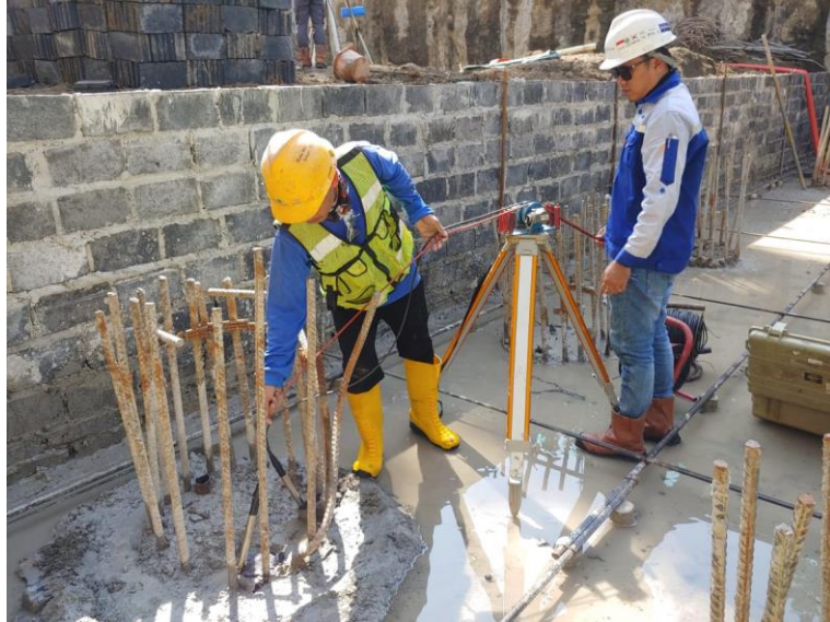
Gambar 48 Proses tes CSL. Sumber : Dokumentasi Lapangan
